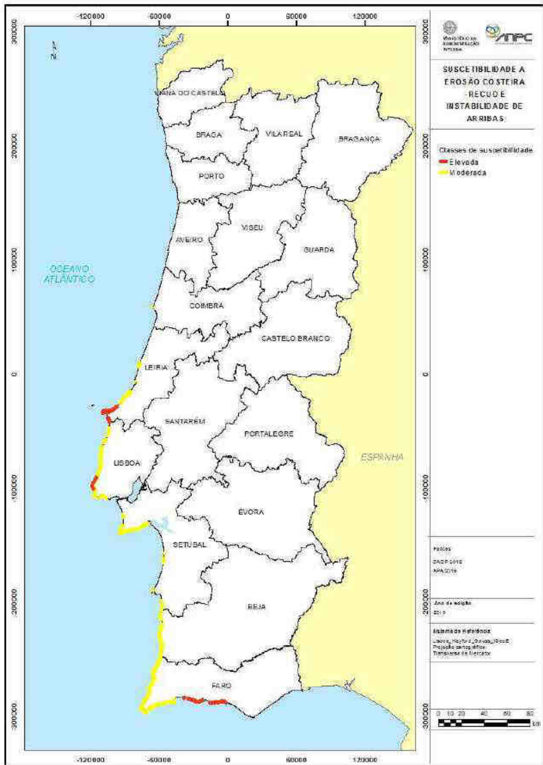
Figura 23 – Carta de suscetibilidade a recuo e instabilidade de arribas (fonte: adaptado de Plano Nacional de Emergência de Proteção Civil - ANPC, 2013)
